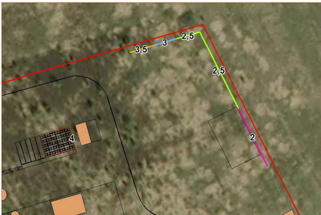
5.34 pav. Rekomenduojamų triukšmą slopinančių sienučių įrengimo vieta ir jų aukštis, m
